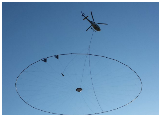
送受信ループをヘリコプターに装着して空中電磁探査を行うヘリコプター
